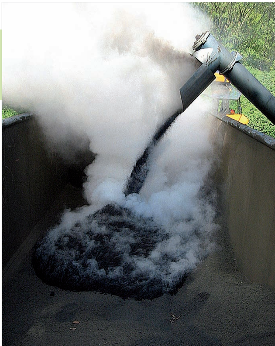
Vidange des granulés de boues d'épuration fumants (auto-échauffement) lors d'un test de stockage à grande échelle dans un silo de 18m 3 .
