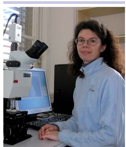
Katja von Allmen vor der «MicroMill». Das mikroskopartige Gerät dient zur präzisen Probennahme in Gesteinen.
