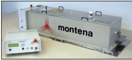
Fig. 2 Générateur d'impulsions 300 kV
