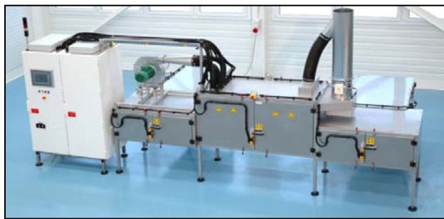
Fig. 7 Machine industrielle traitant plusieurs milliers de cakes ou de pains / heure à la lumière pulsée
