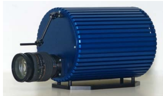
Fig. 9 Caméra avec son objectif et son système d'orientation du faisceau laser
